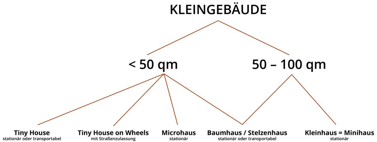
**Abbildung 1: Ordnungsstruktur von Kleingebäuden**
